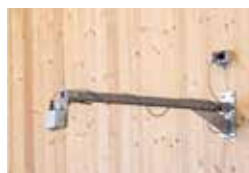
Wärmebildsensor erkennt das Kalb im Gefahrenbereich
